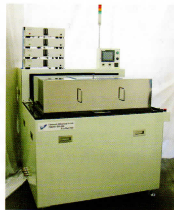
新型の精密成形品用バリ取り洗浄機「PERION-DB II-4800」
